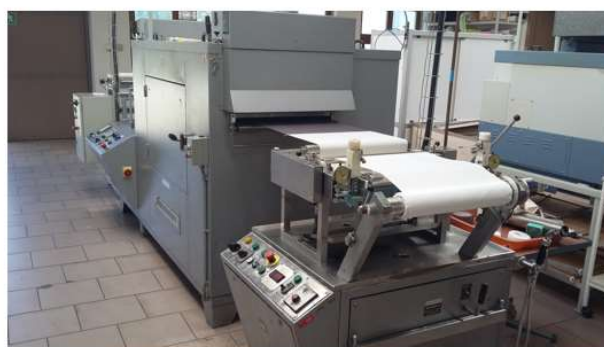
INOTEX – ensayos de laboratorio de acabado DWR TEXAFOB ARK mediante proceso de impregnación-secado-curado: Efecto repelente al agua
