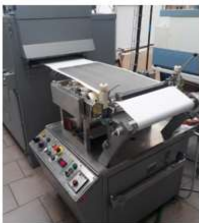
INOTEX – ensayos de laboratorio de acabado DWOR 3294_IPDI_2 / SWCNT 0,1 % por recubrimiento: combinación de revestimiento estanco con nanotubos de carbono: efecto estanco/antiestático
